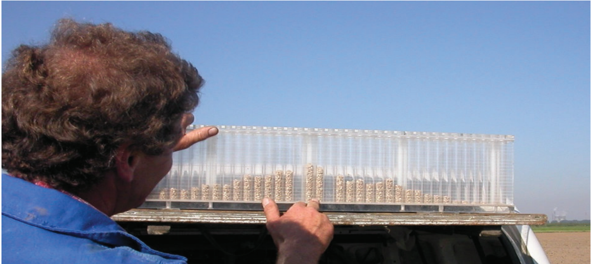
Abb. 14: Überprüfen der Verteilgenauigkeit durch das Streubild (Foto: Renate Block)
